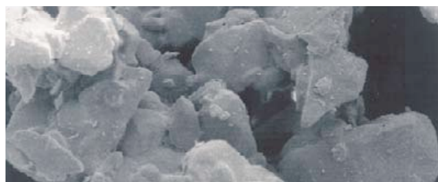
Instant Sugar-partikel förstorad 600 gånger. Bilden visar porositeten hos partikeln.
